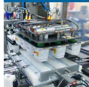
Das System ermöglicht Verpackung von weichen Produkten, da das Produkt selbst nicht als Stütze genutzt wird. Der schonende Umgang mit Einzelverpackungen ist dank des kontrollierten Beschleunigungs- / Bremsprinzips möglich. Das Antriebssystem ist in eine Sicherheitskupplung mit Alarmsystem ausgestattet.
